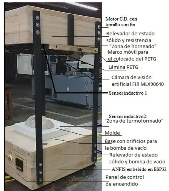
Fig. 6. Termoformadora de blísteres con control *ANFIS* embebido mediante cámara de visión artificial FIR *MLX90640*
